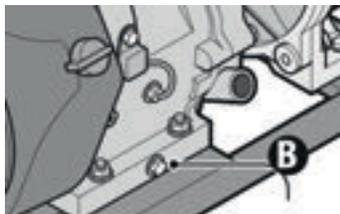
Coloque un contenedor adecuado debajo del motor para recibir el aceite, retire el tornillo de drenaje y después el tapón del tanque
