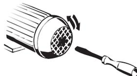
En la **bomba periférica**, por diseño, su rotor tiene tendencia a pegarse al cuerpo en presencia de aguas duras sobre todo cuando queda inactiva varios días con agua en su interior.
