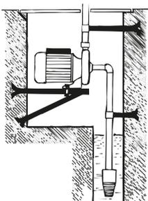
Las cañerías deben tener un diámetro igual o mayor a los orificios de la bomba. En caso que la aspiración supere los 4 metros, o que el tramo horizontal de aspiración sea grande, es indispensable montar un caño de aspiración con diámetro superior al de la bomba.
