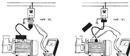
**ATENCIÓN:** Verifique que la tensión de alimentación coincida con los datos de la placa del motor. Si así fuera, empalme los cables a la bornera. Verifique el voltaje en las bombas mientras la bomba funciona: **LA TENSIÓN NO DEBE VARIAR MÁS DE 5% DEL VALOR NOMINAL.**
