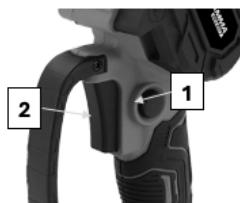
Su sierra dispone de un sistema de traba de seguridad (1) que debe ser presionada para activar el botón de encendido. (2).
