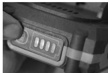
Cargue la batería antes de que se agote por completo. El nivel de carga se puede observar pulsando el botón en la batería.
