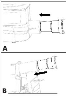
3. Destornille el vaso de la pistola rociadora. Luego, alinee el tubo de succión para que se pueda tomar la totalidad del líquido.
