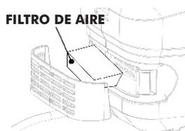
**⚠ PRECAUCIÓN:** Nunca use el motor si no está el filtro de aire colocado; la suciedad puede ser absorbida interfiriendo con el funcionamiento de la máquina.
