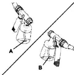
Cuando rocíe con la pistola en posición horizontal coloque el tubo de succión hacia adelante (A). Cuando deba rociar apuntando la pistola hacia arriba, el tubo de succión debe colocarse apuntando hacia atrás (B).
